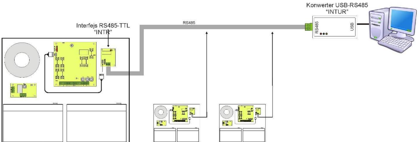
Fig. 20. RS485 communication using the „INTR” and „INTUR” interfaces.
